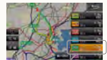
燃費優先ルート以外のルートも探索結果画面で選択可能。
