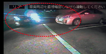
■従来カメラの画像(14年モデル) 後続車両のヘッドライトが「白とび」している。
