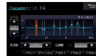
■パラメトリックEQ 特定の周波数帯域のレベルを調整する機能で、きめ細かな補正を行っています。
