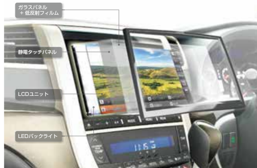
新開発スーパークリアパネル LCDの映像を、鮮明なまま映し出すパネル。圧倒的な美しさを実現します。
