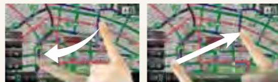
フリック操作 画面を指で軽くはらう(フリック)するように動かすと、地図画面がフリックした方向に移動します。 ドラッグ操作 画面を指でタッチしたまま(ドラッグ)するように動かすと、地図画面が指の動きに合わせて移動します。
