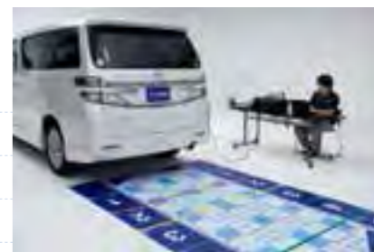
より正確なガイド線を実車で計測。
