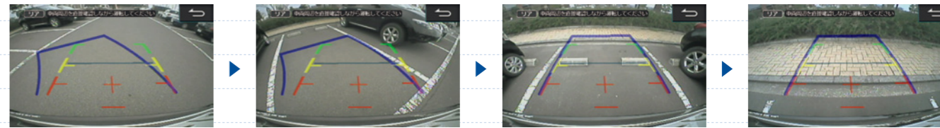
後退時はナビ画面に映る正確なガイド線で、より安全に駐車。(イメージは、ステアリング連動バックビューカメラ/SGS-C920Dシリーズ装着時のものです)
