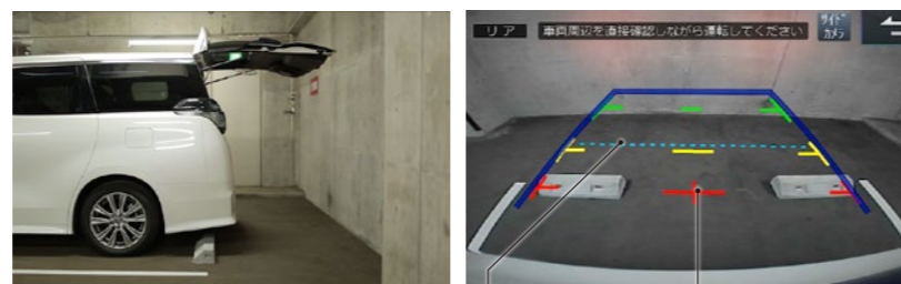
バックドアガイド線 バックドア開閉時に配慮した ガイド線です。 距離目安マーク 約0.5m、約1m、約2mの目安を 赤・黄・緑で示します。
