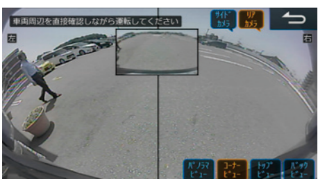
コーナービュー 左右及び後方の3映像を同時に表示します。
