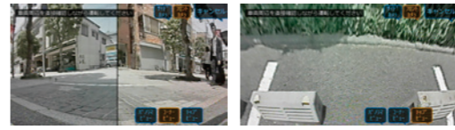
コーナービュー 左右の様子を詳しく確認できます。 トップビュー クルマの上から見下ろした映像を表示。
