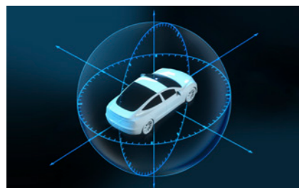
緯度/経度/高度のそれぞれで、加速度情報と角速度情報を取得。
