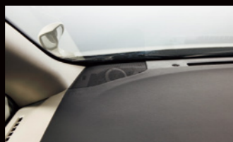
最適な位置・角度に取付けられる「ツイーター取付けキット」
