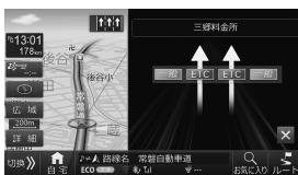
ETCレーン情報のある料金所が近づくと表示されます。ETC・ETC2.0車載器(別売)にETCカードが装着されている場合はETCレーンに矢印が表示されます。
