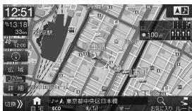
レーン情報のある分岐交差点が近づくと(約10km以内)、交差点までの距離と走行レンジが表示されます。
