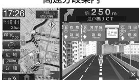
有料道路や高速道路を走行中に情報のある分岐点(JCT)が近づくと表示されます。レーンごとに方面が表示されます。
