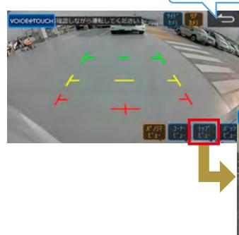
車両を後退させているとき、例えば「トップビュー」と発話すれば瞬時にアングルが切り替わり後方を確認できます。
