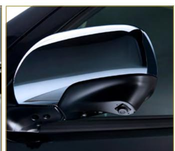
後方を映すバックカメラ。車両左側を映すサイドカメラ。
