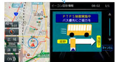
注意喚起情報が割り込むとき、画面に突然現れる情報ウィンドウ。情報を確認したら「キャンセル」のひと声ですばやく元の画面に戻せます。
