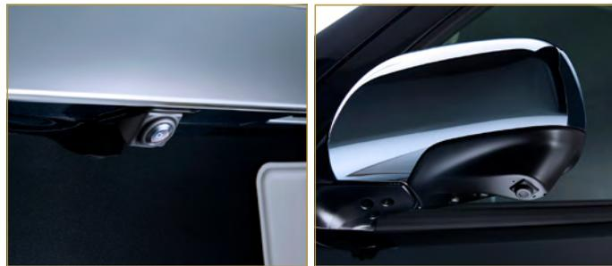
後方を映すバックカメラ。車両左側を映すサイドカメラ。
