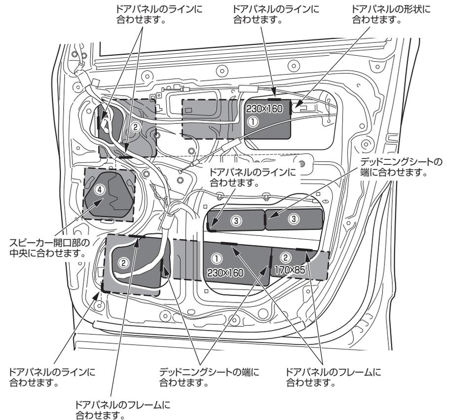
2) 下図を参照してフロントドアパネル表側の鉄板にデッドニングシートを貼り付けます。
