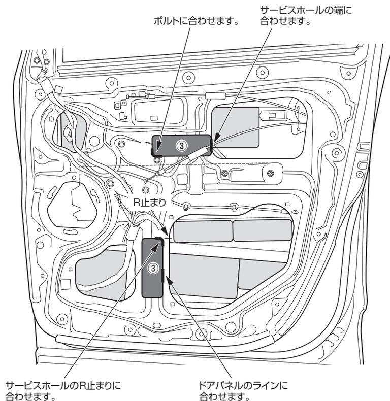
3) 下図を参照してフロントドアトリムにデッドニングシートを貼り付けます。
