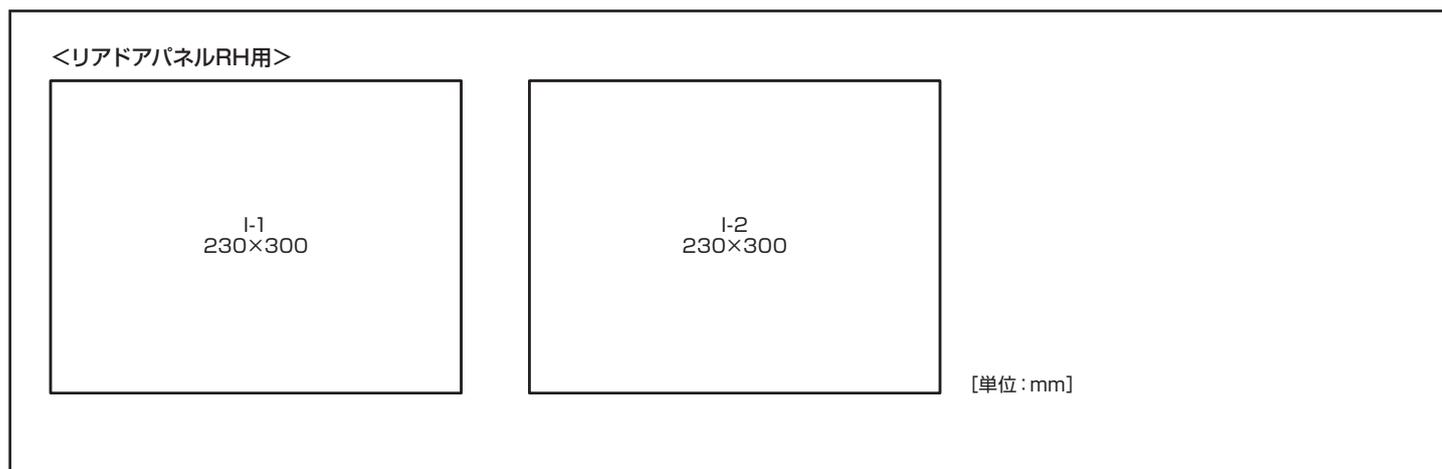
2. ②吸音シートを下图に従ってカットして、リアドアパネルRH用の②吸音シートを準備します。
