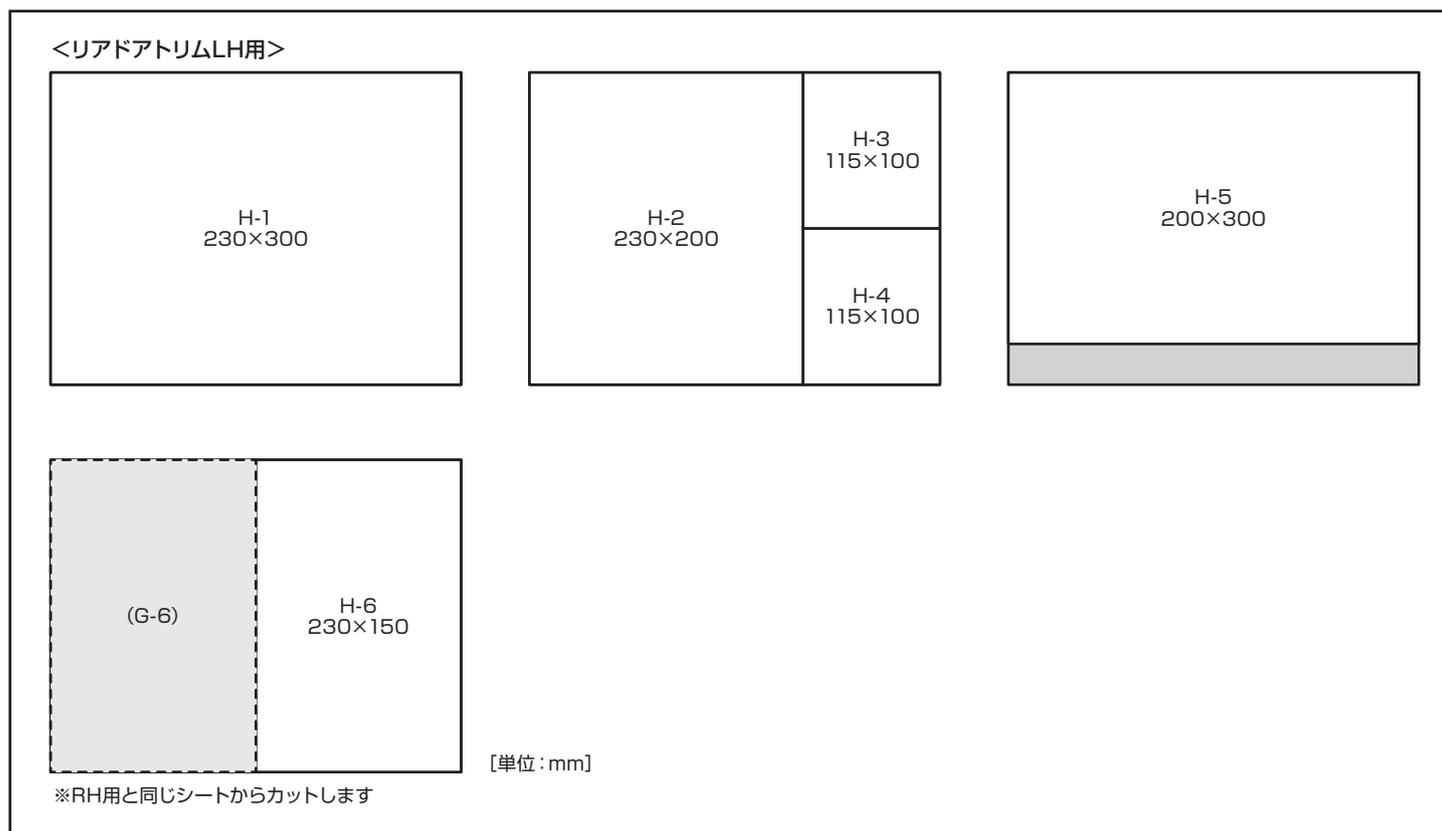
2. 下図を参照してリアドアトリムLHに①静粛性向上シートを貼り付けます。
