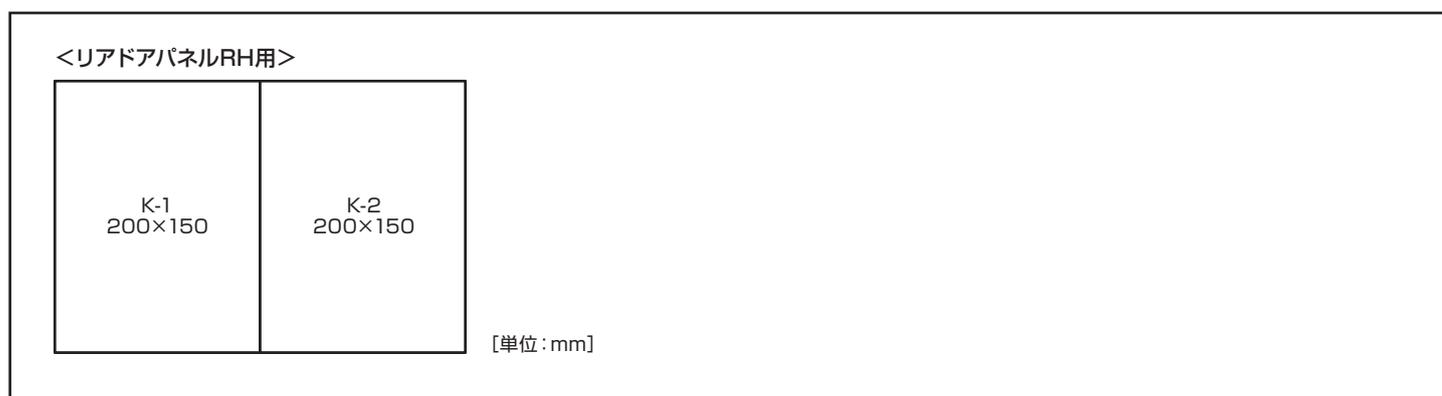
3. 下図を参照してリアドアパネルRHに①静粛性向上シートと②吸音シートを貼り付けます。
