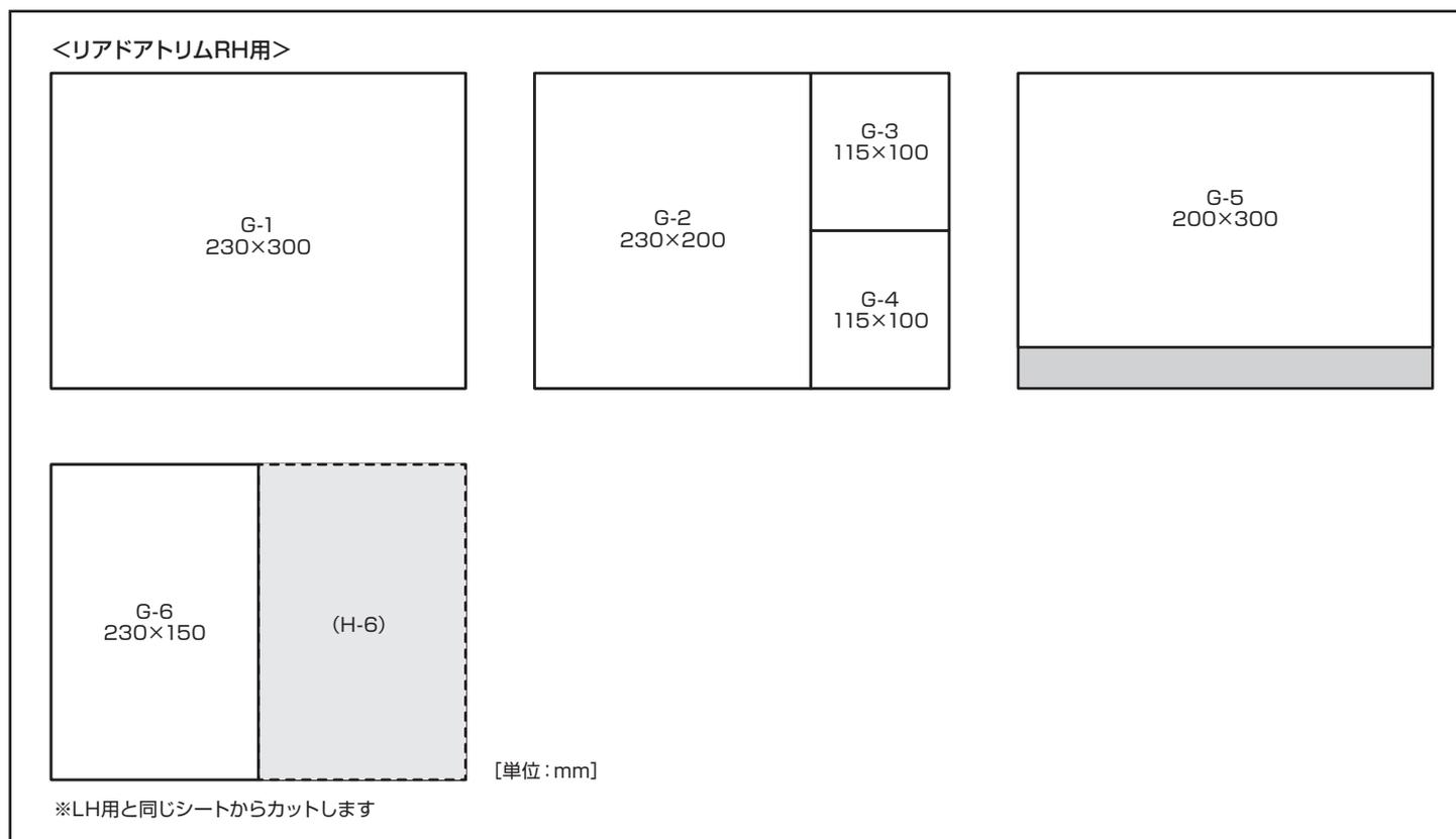
2. 下図を参照してリアドアトリムRHに①静粛性向上シートを貼り付けます。
