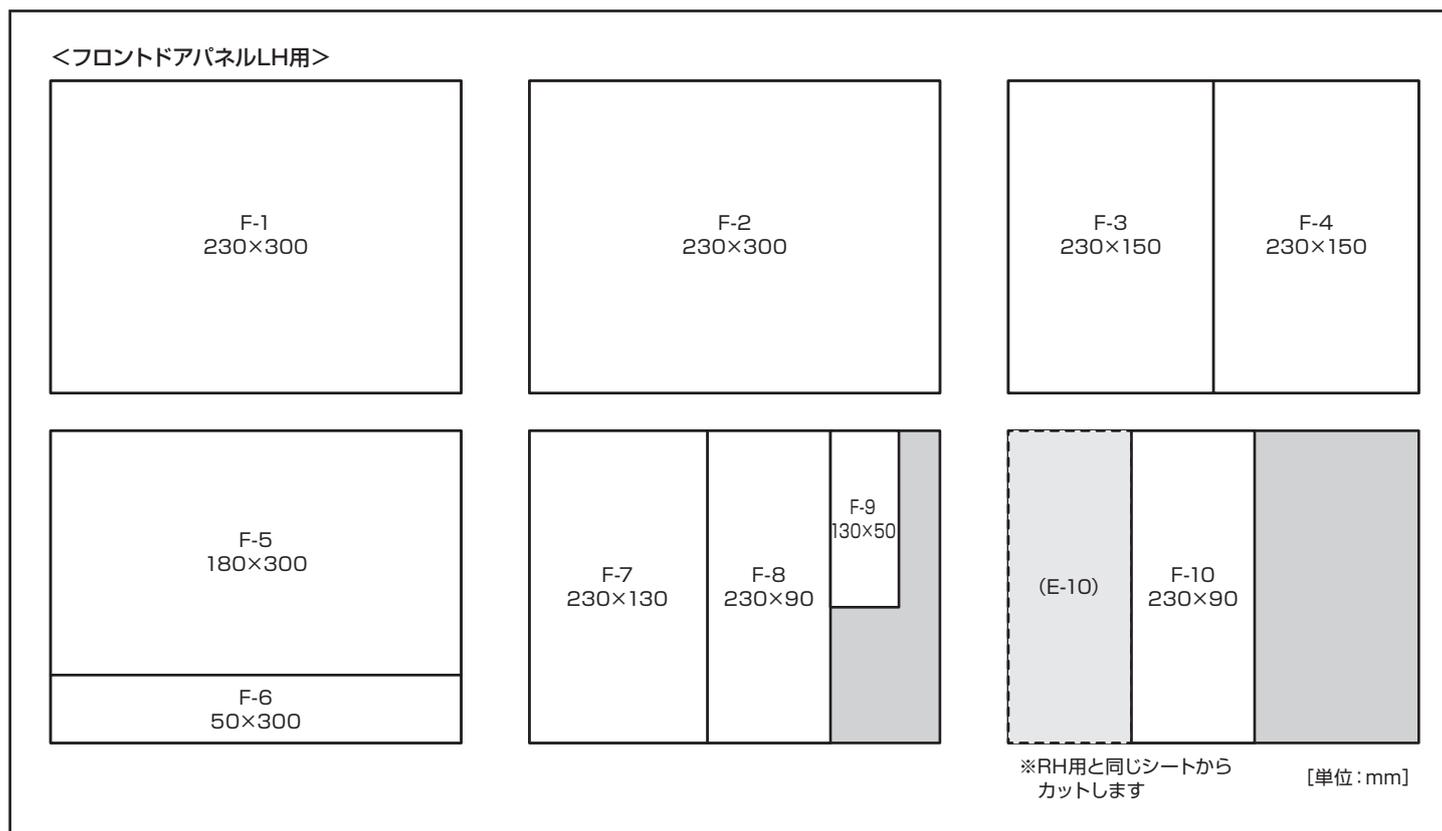
2. 下図を参照してフロントドアパネルLHに①静粛性向上シートを貼り付けます。
