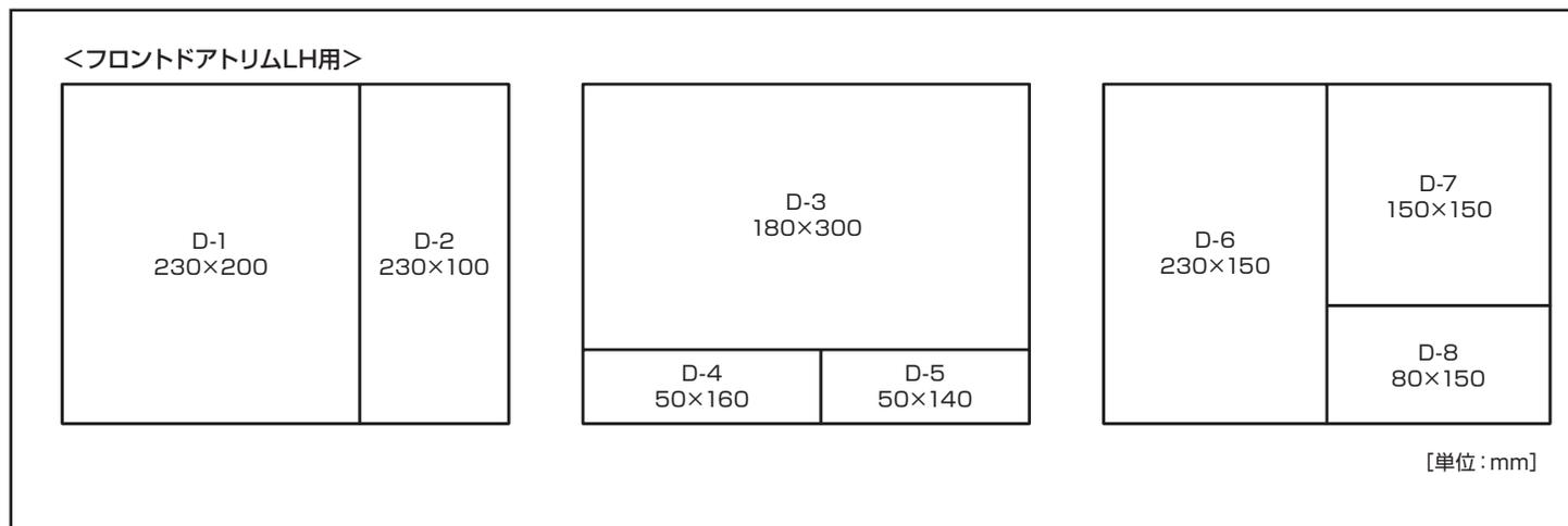
2. 下図を参照してフロントドアトリムLHに①静粛性向上シートを貼り付けます。
