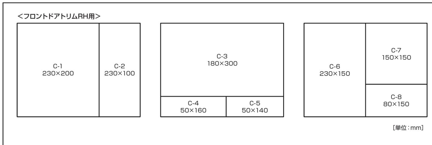
2. 下図を参照してフロントドアトリムRHに①静粛性向上シートを貼り付けます。
