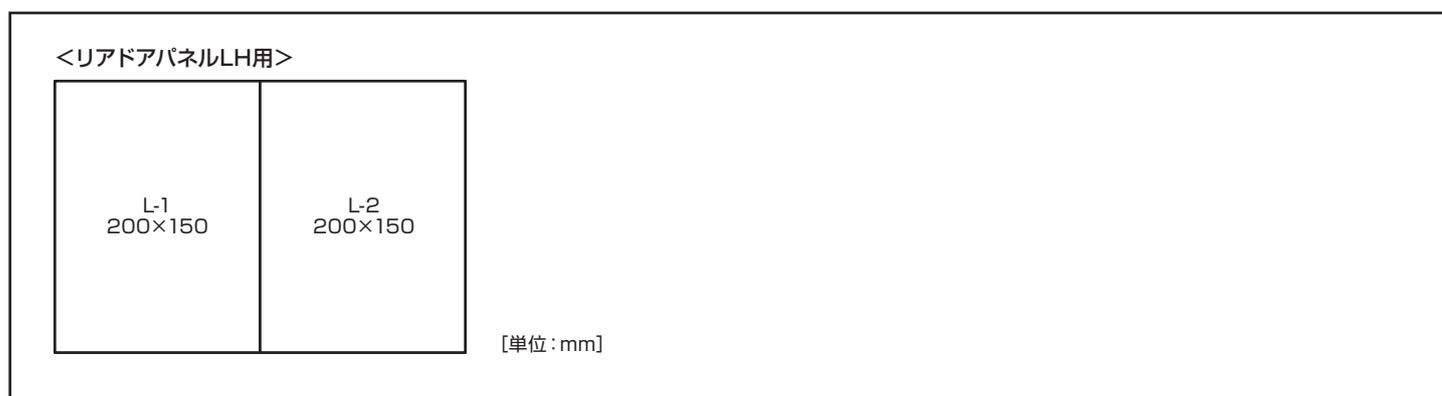
3. 下図を参照してリアドアパネルLHに①静粛性向上シートと②吸音シートを貼り付けます。
