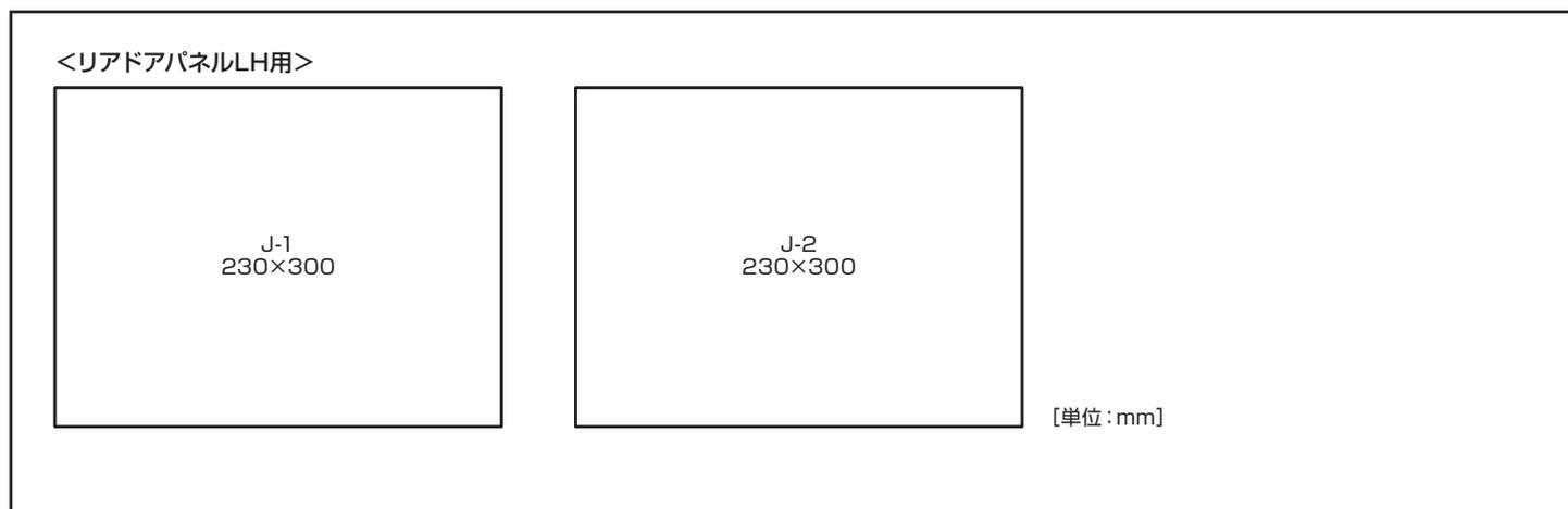
2. ②吸音シートを下图に従ってカットして、リアドアパネルLH用の②吸音シートを準備します。
