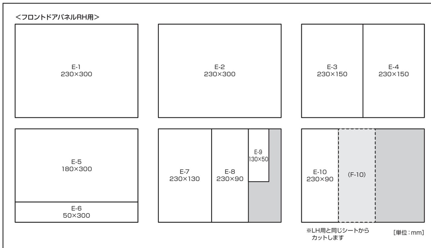
2. 下図を参照してフロントドアパネルRHに①静粛性向上シートを貼り付けます。
