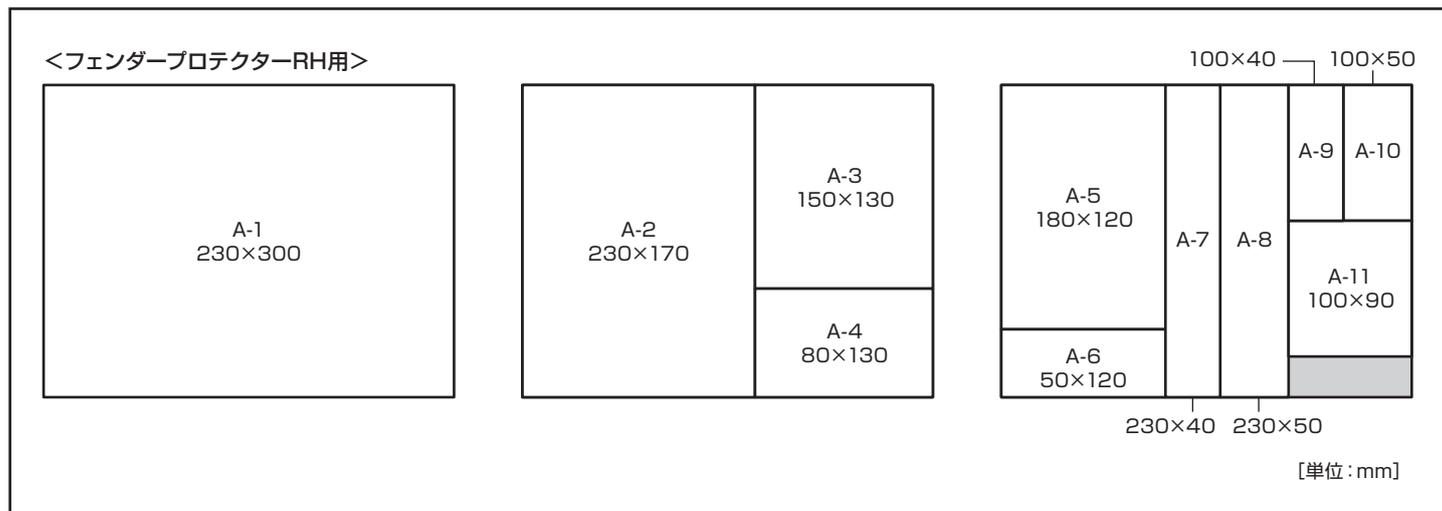
2. 下図を参照してフェンダープロテクターRHに①静粛性向上シートを貼り付けます。
