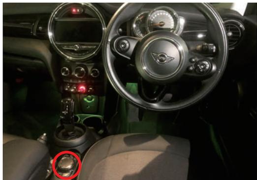
ナビ操作は全て運転席左側にあるコマンドーで操作します。
