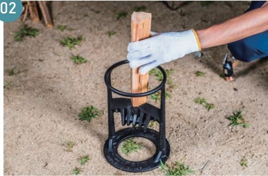
薪割とハンマーを用意します。右図のように薪を縦にセットします。
