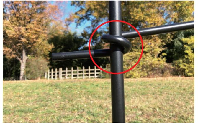
根元部分をポールを用いて打ち付けます。きちんと刺し終わったら、根元部分にポール本体を挿入し、各ハンガーを付けていきます。この際、向きに注意してください。
