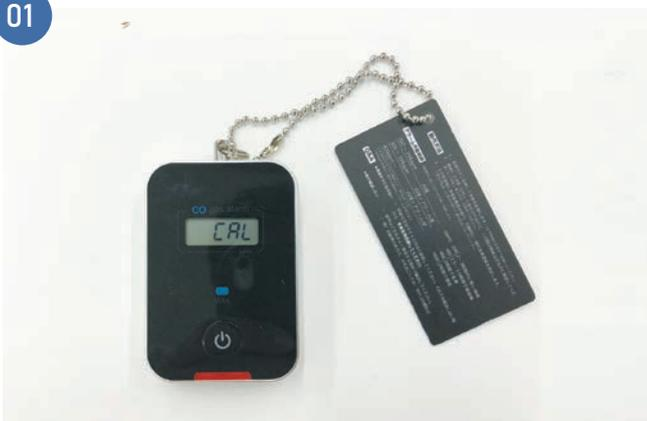
電源ボタンを長押しすると液晶画面にCALが表示されますので3
