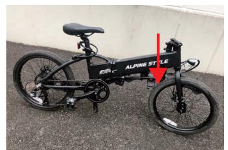
レバー抜け防止のフックを抜いて、レバーを手前に倒してハンドル部分の後ろ側に倒します。
