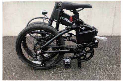
フレーム部分中央にあるレバーのスイッチを矢印の方向に押しながら手前に開くと、ロックが外れて自転車を折りたためます。
