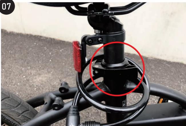
最後にサドルの下にあるレバーを引いてサドルの高さを調整したら完成となります。
