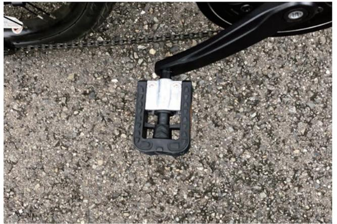
折りたたんであるペダルを上方向に押しながらかち上げた状態で車体側に動かすとペダルが地面と平行になり漕げる状態になります。
