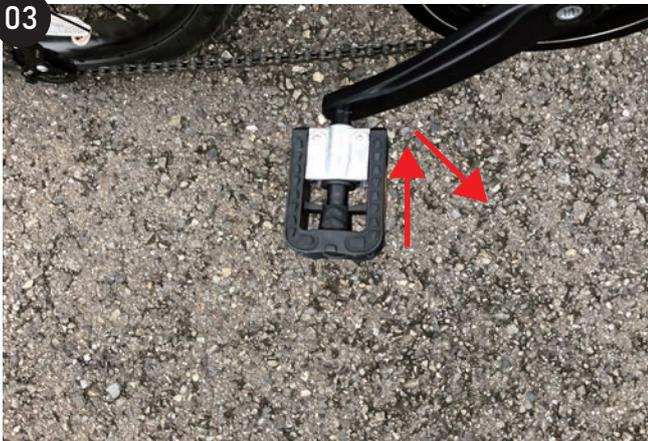
ペダルを車体側に押しながら下方向に押してペダルを畳みます。
