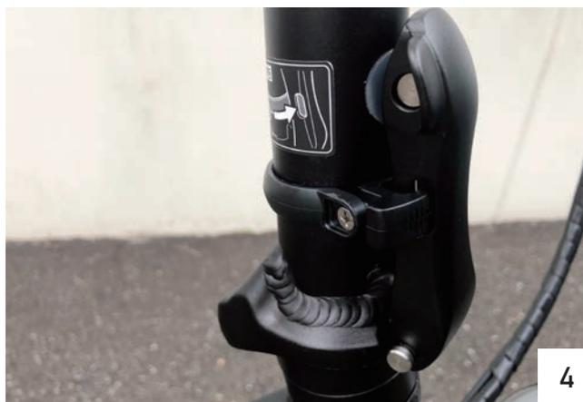
後方に倒れているハンドル部分を引き起こして、レバーを押して固定します。
