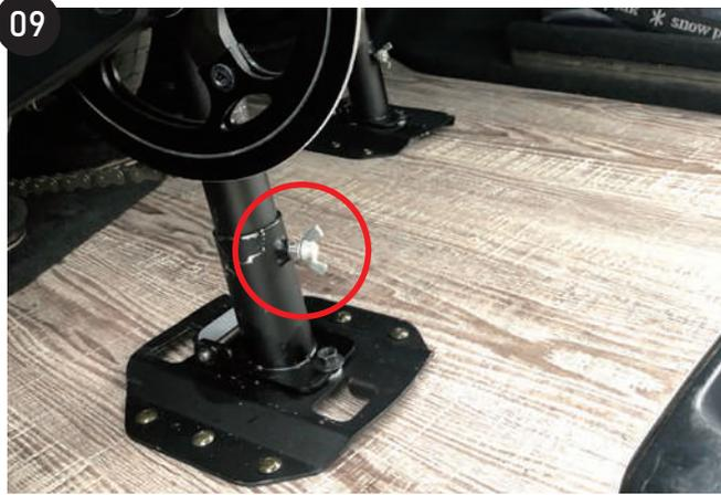
最後に「サドルポール固定治具」のネジを締めて固定したら完了です。
