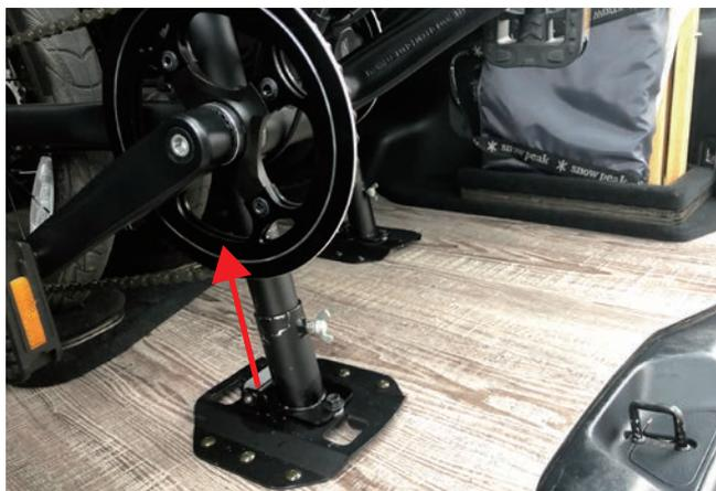
丸で囲った2か所を持ち、固定治具から矢印の方向斜め後ろ方向に自転車を持ち上げて自転車を車から降ろします。
