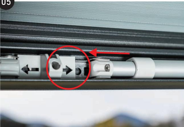
根元部分を押し込み、レグを収納します。反対側も同様に収納してください。
