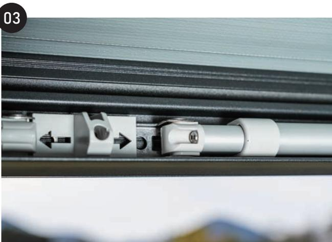
03 オーニング先端部分の中央にあるオーニングレグの根元部分を前に引き、図のように脚の先端を引き抜きます。
