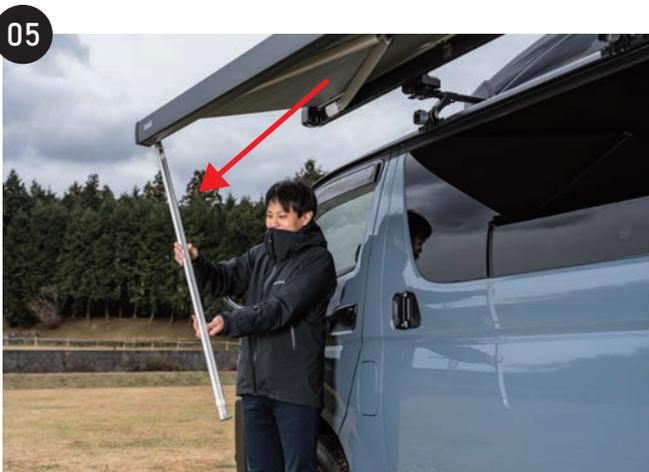
05 矢印の向きにオーニングレグを下ろし、つまみで足の長さを調節し、地面に接地します。反対側も同様に行ってください。
