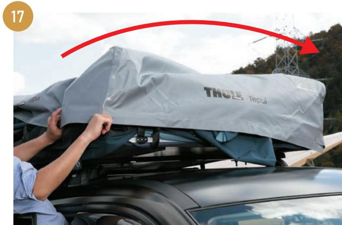
助手席側にあるカバーを固定しているマジックテープを外して、運転席側にカバーを掛けていきます。
