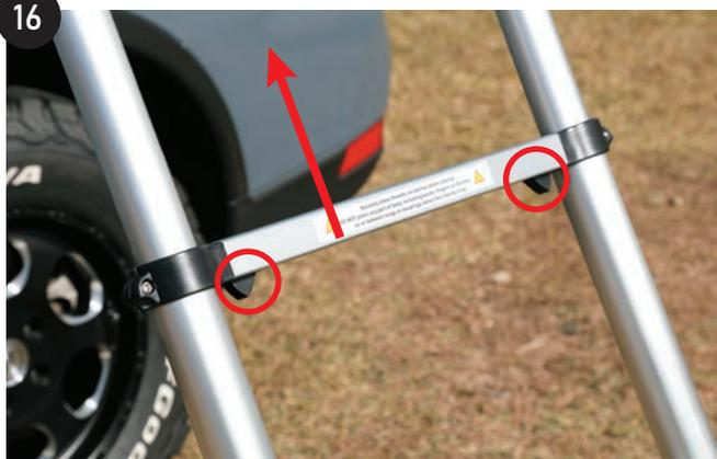
はしごの上段側の各ステップ下側にある黒い突起を押して、長さの調整をします。
