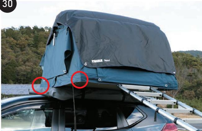
前方側、後方側も下側にあるホール2か所(合計4か所)にポールを助手席側、運転席側と同様に差し込みます。
