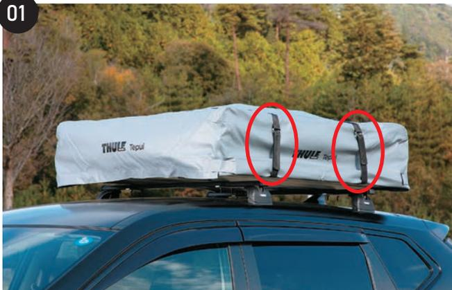
カバーを固定しているロープ2本を外します。
