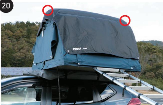
入口側(助手席側)と反対側(運転席側)の上部2か所にあるポールをガイドに差し込みます。
