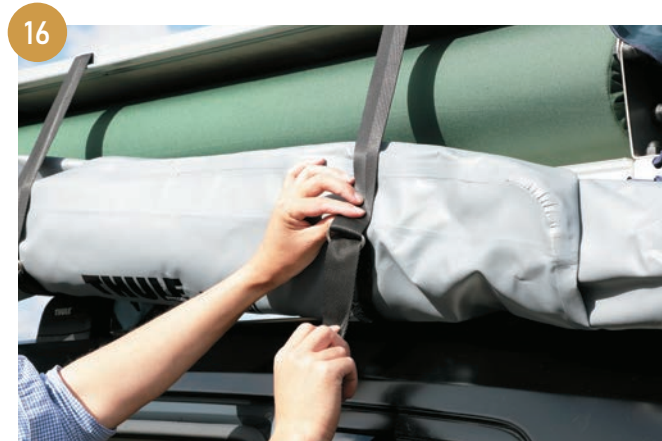
助手席側にあるカバーを固定しているマジックテープを外して、運転席側にカバーをかけていきます。
