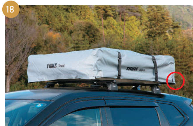
助手席の後方側にある角のマジックテープを外し、本体とファスナーで固定していきます。
