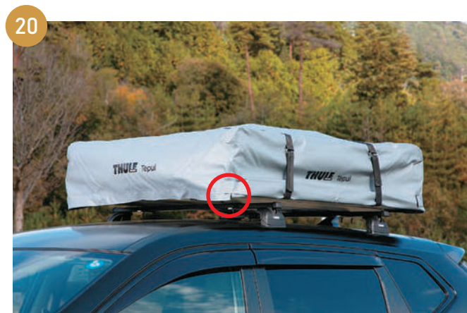
助手席の進行方向側までファスナーで留めた後、ファスナーをカバー内側へ収納し、マジックテープで固定します。
