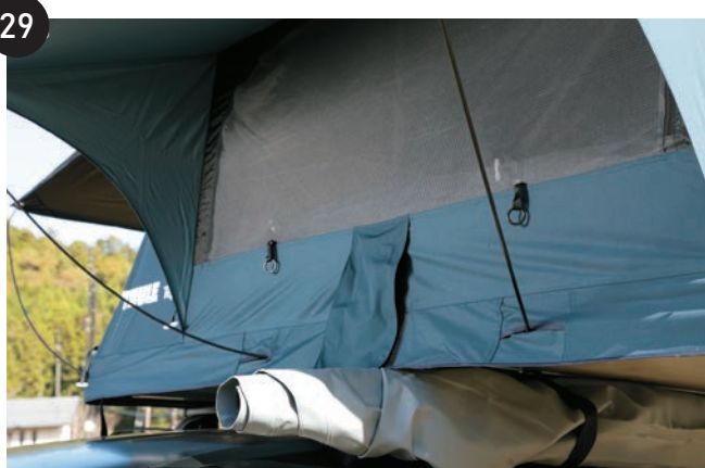
黒いレインフライの左右2か所にあるホール(展開時に留めていたホール)に先端のフックを引っ掛けて、ポール部分をたわませて取り付けます。
