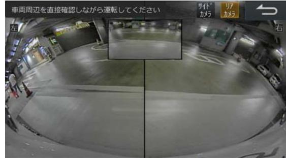
■ マルチビュー・サイドカメラ 画像表示例（左ドアサイド/ドアミラーをたたんだ状態の左後方）
